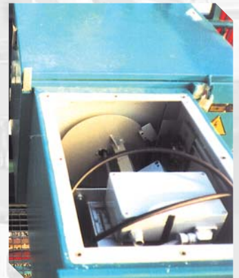
Detalle de colector con 6 fibras ópticas montado en arrollador para cable de 10 KV + 6 fibras ópticas.
