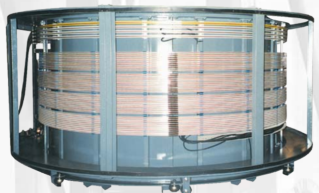
Columna colectora para parque circular de carbón, tubo central Ø 2,500 mts.
