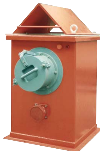
Toma de corriente tipo "Monaguillo" en acero galvanizado y pintado, con toma de corriente principal de 630 A y auxiliar de 125 A enclavadas con contactor y fusible.
