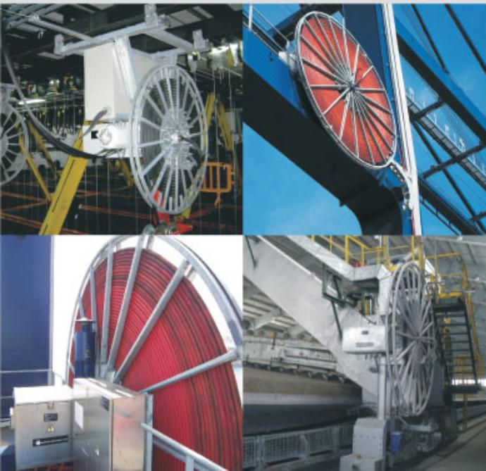
在风机冷却或常温下的磨损和力矩的变化是没有问题的，电缆的张力可以通过改变电源电压来调整。
